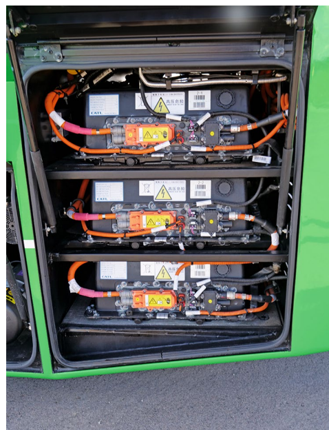
Die Batterien sind im Heck hinten links untergebracht, bei Bedarf geht es auf dem Dach weiter
